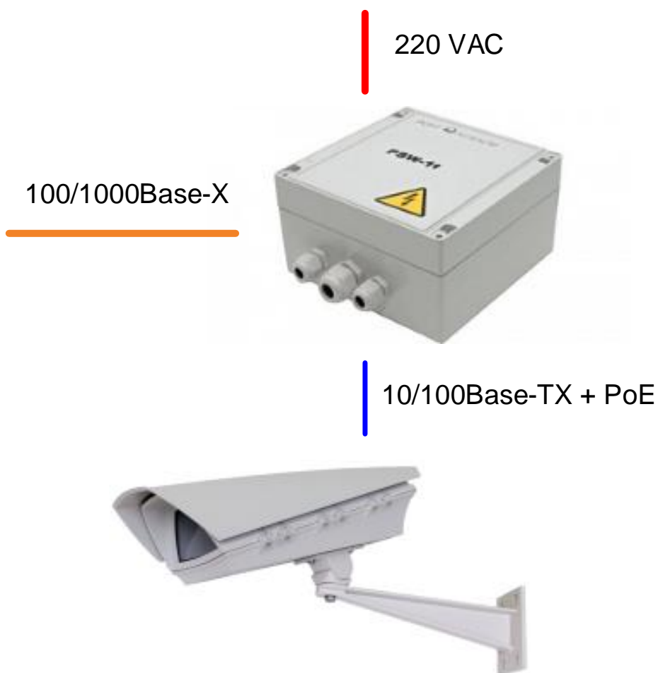
Рисунок 1 - Схема подключения PSW-11
