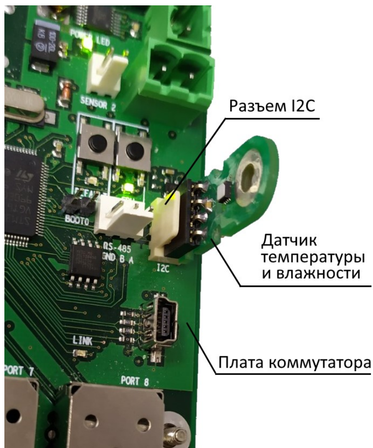
Рис. 4 Установка датчика на плату коммутатора.
