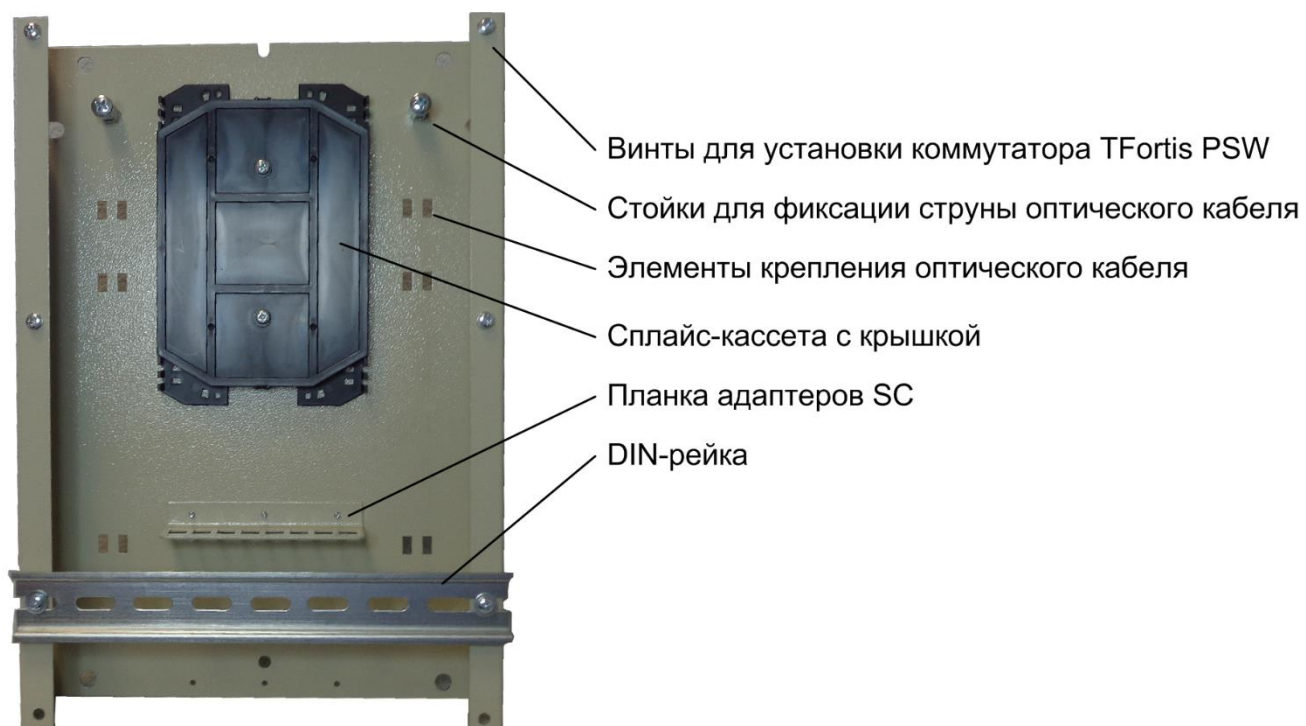
Рисунок 2.2.1 - Оптический кросс
