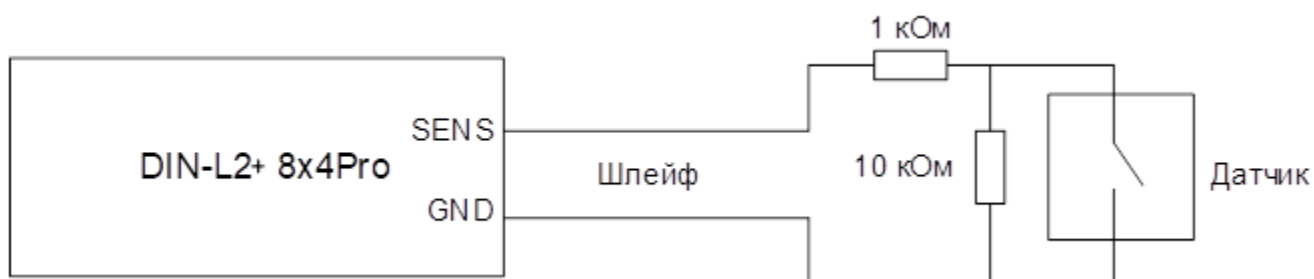
Рис. 3.8.2 Схема подключения датчика с контролем шлейфа
