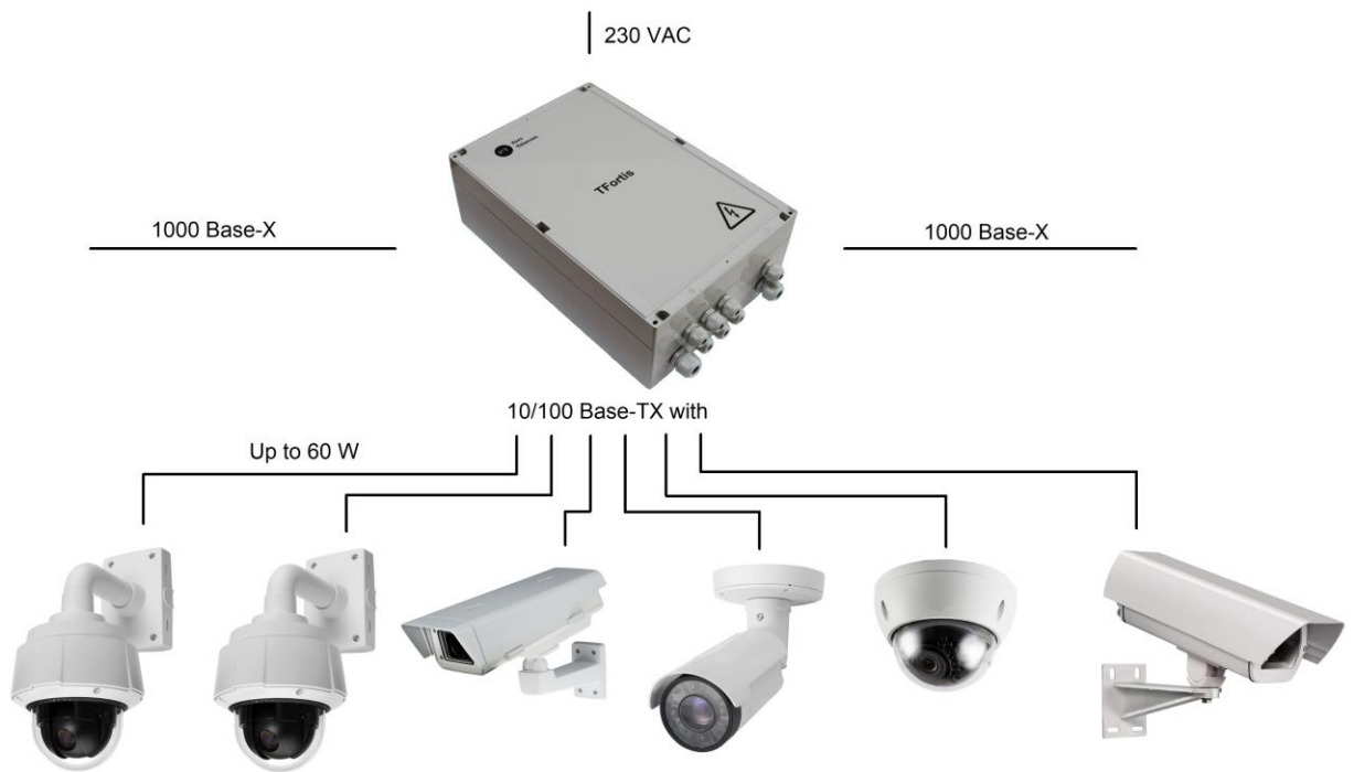
Рисунок 1 - Схема подключения PSW-2G6F+
