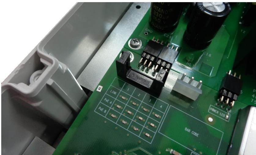
Рисунок 3.5.1 - Датчика вскрытия на плате
