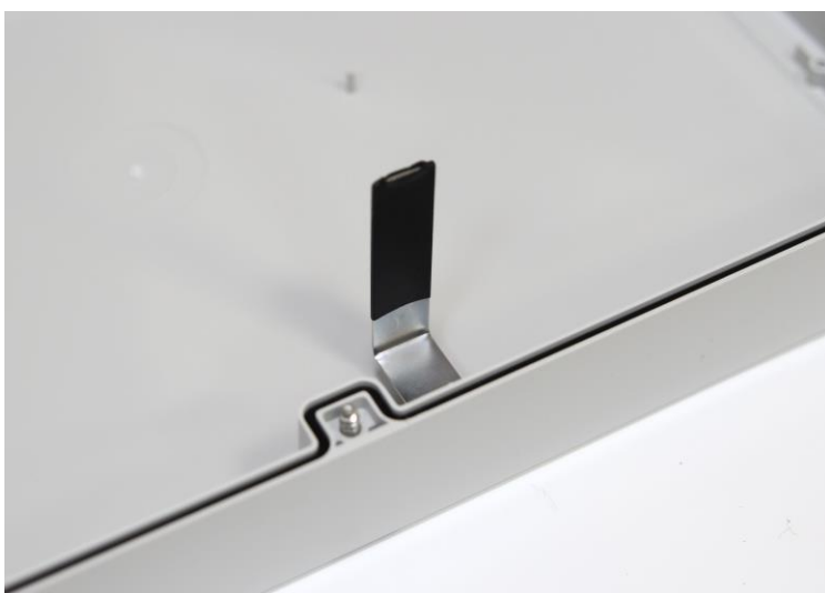
Рисунок 3.5.2 - Шторка датчика вскрытия на крышке коммутатора
