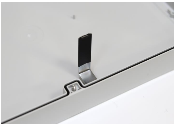
Рисунок 3.5.2 - Шторка датчика вскрытия на крышке коммутатора
