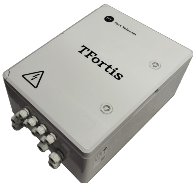
Рисунок 3.1.1 - PSW-2G+Box - вид снаружи
