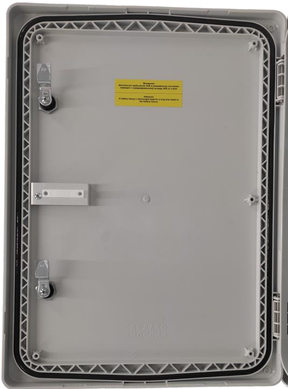
Рисунок 3.6.1 - Датчик вскрытия на крышке коммутатора
