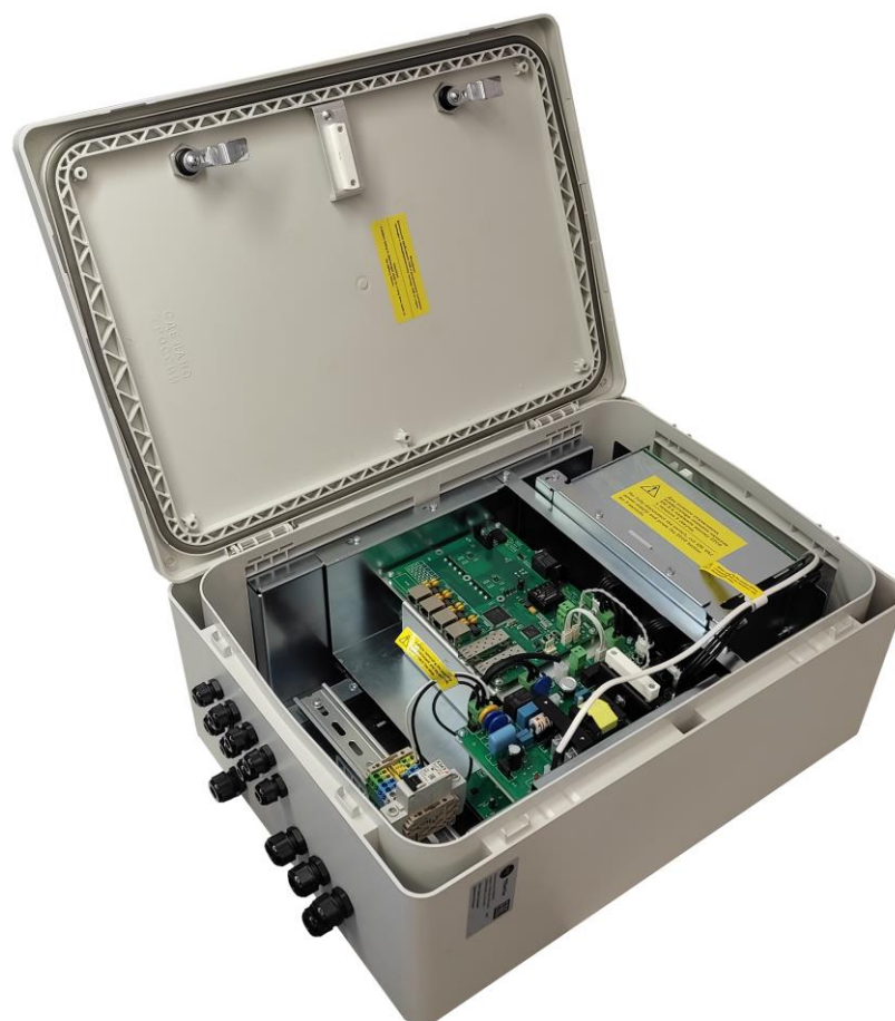
Рисунок 3.1.2 - Коммутатор PSW-2G+UPS-Box - вид внутри
