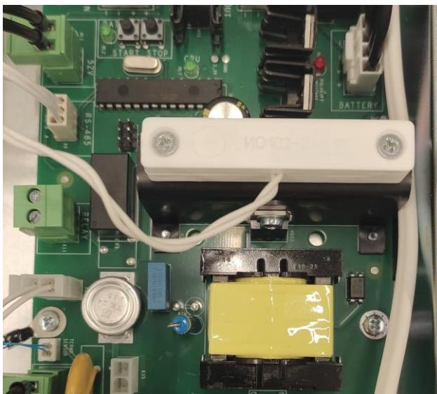
Рисунок 3.6.2 - Датчик вскрытия в корпусе коммутатора.
