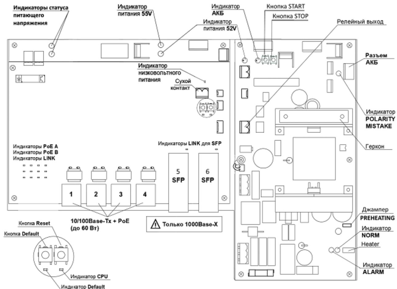
Рисунок 3.4.1 – Расположение элементов PSW-2G+UPS-Box
