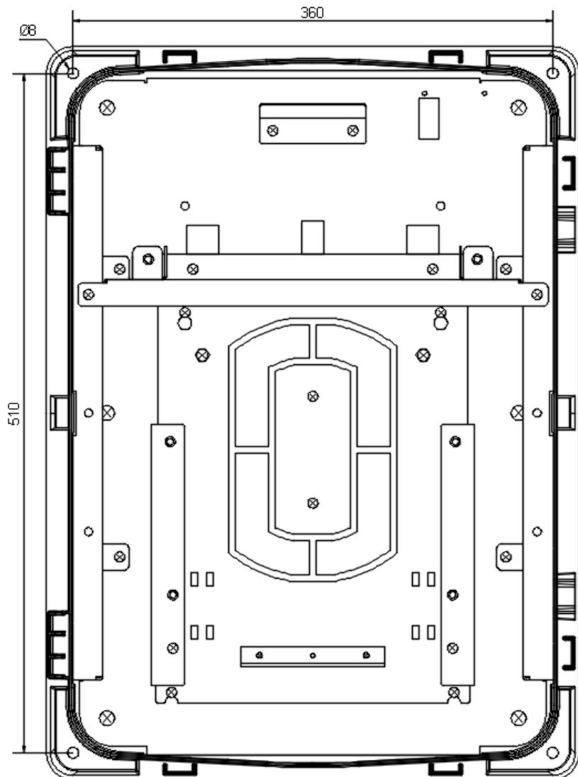
Рисунок 7.2 - Разметка крепления
