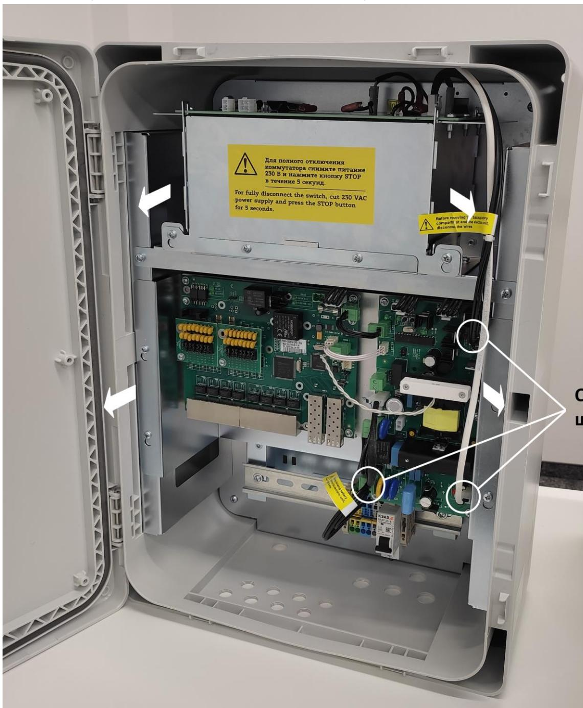
Рис. 7.1.1. Извлечение отсека АКБ и электронного узла
