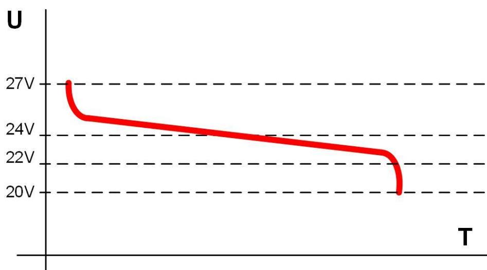
Рисунок 3.10.3 – Снижение напряжения при разрядке АКБ.
