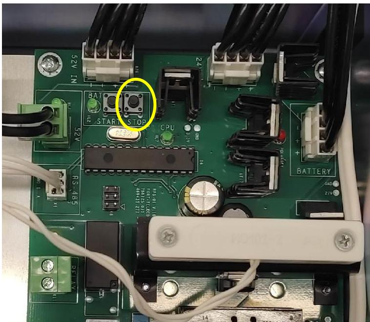
Рисунок 3.4.2 – Нажмите и удерживайте кнопку STOP в течение 5 с для отключения питания от АКБ.
