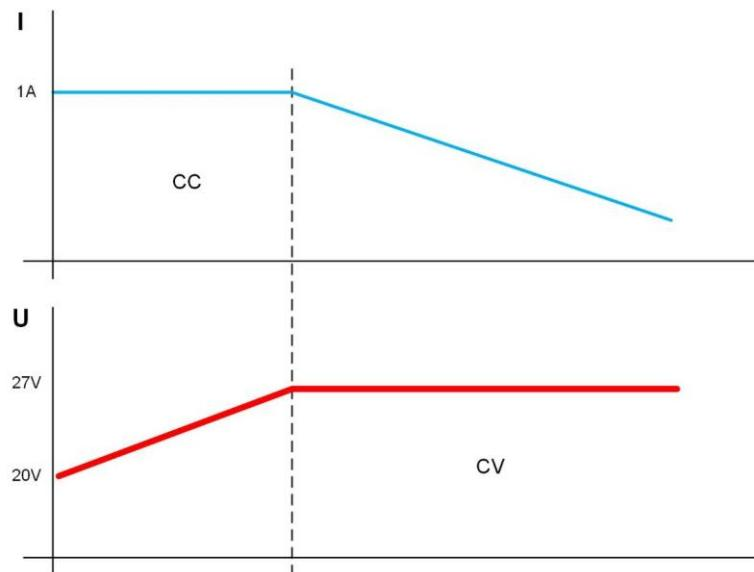
Рисунок 3.10.2 – Зависимость постоянного тока и напряжения заряда АКБ.
