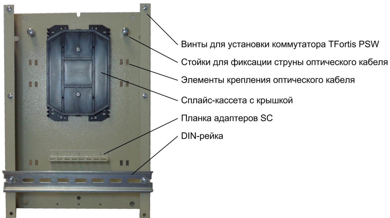
Рис. 3. Оптический кросс
