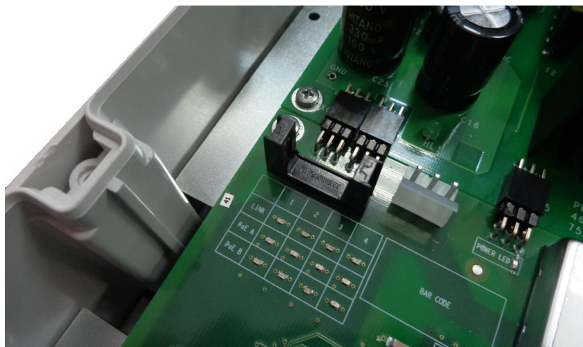
Рисунок 3.5.1 - Датчика вскрытия на плате
